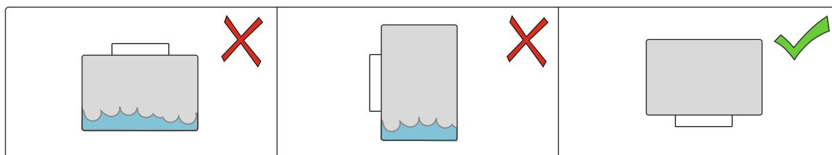
Блок устанавливать строго разъемом вниз во избежание скопления конденсата.
